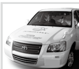
水素から、燃料電池「トヨタFCスタック」で電気をつくり、モーターで走る「トヨタFCHV-adv」
