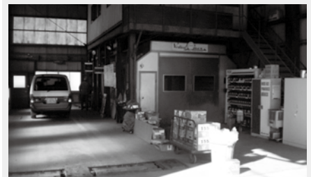
▲ 塗装ブースと検査ラインが併設され効率化を図る
