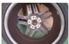
ブレーキダストがこびりついた超音波洗浄する前のホイール
