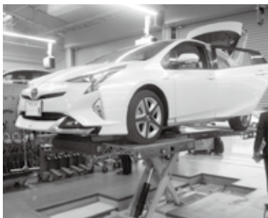
最新型のプリウスをフレーム修正中
