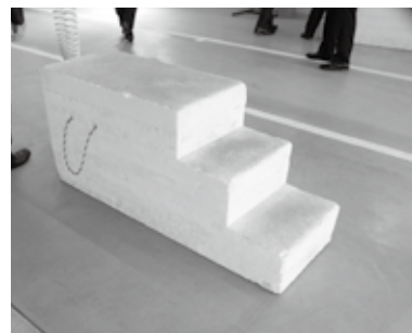
作業用のステップを発砲スチロールで自作
