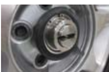
ホイールの固定はエアでペダルを踏むだけ!
