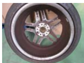
ブレーキ出すがこびりついた 超音波洗浄する前のホイール
