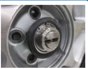
ホイールの固定はエアで ペダルを踏むだけ!
