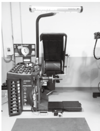
ホイールバランサーのみならず、タイヤ、ホイールから発生する振動を解決し、ホイールアライメントで車両の横滑りも修正可能なバランサー
