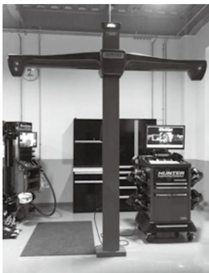
カメラセンサーやターゲットのワンタッチ取り付けで精緻かつスピーディーなアライメント作業が可能なホークアイエリート
