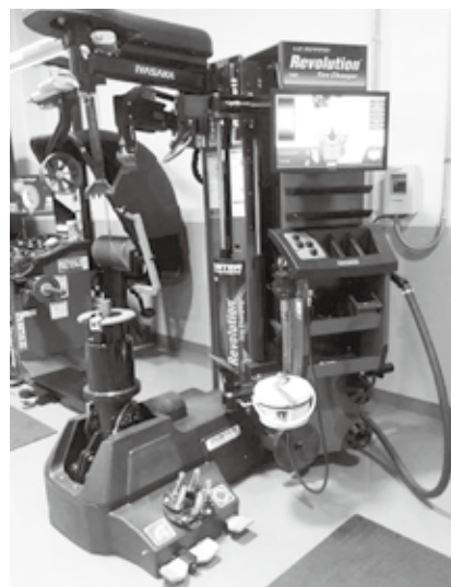
フルオートマチック化されたレバーレスタイヤチェンジャーで、容易にタイヤ交換が可能
