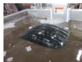
ホイールは洗浄層に入ると 自動回転で攪拌洗浄!
