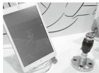
記録・発信を司る TORQULE を装着したトルクレンチ
