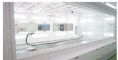
大きなガラス窓の採用で大人数でも内部が確認可能な塗装ブース
