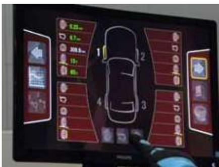
上記の「Fomulra UNIFORMITY」に付属のモニター。4輪のロードフォース測定後、前後左右どの位置にどのタイヤ・ホイールを組み付ければ最適かを自動診断し、入れ替えの指示を表示する。
