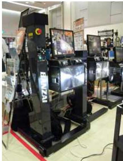
フルモデルチェンジした最新式全自動ヘッドライトテスター「HT-538」(参考出品)。隣の1代前のモデルと比べてもカメラが高解像度で、よりクリアになっているのが一目で分かる。
