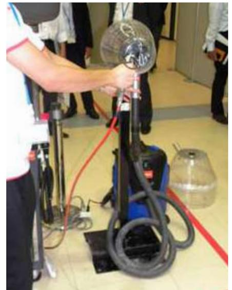
小型車用ブレーキダストクリーナー「BDC-250」。ドラムブレーキ清掃の際に粉塵を飛散させないよう、ブレーキを覆うカバーが付いている。吸引力が強力で作業中にカバーが外れるということもない。
