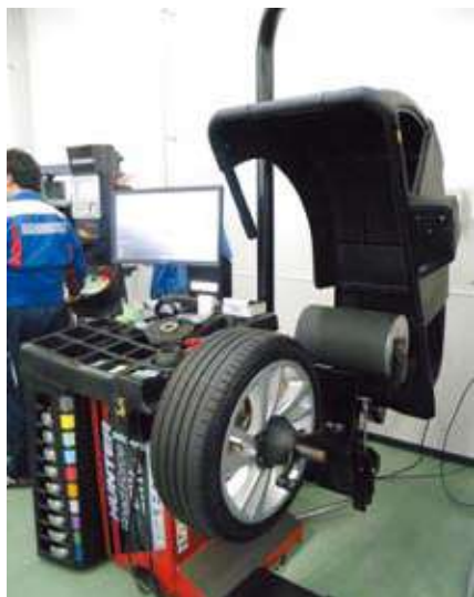
レーザー光だけでタイヤの歪みが分かるユニフォームティーマシン
