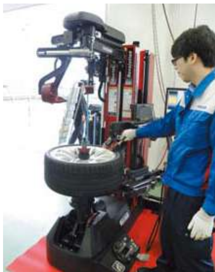
タイヤをセットすれば後は完全自動のタイヤチェンジャー
