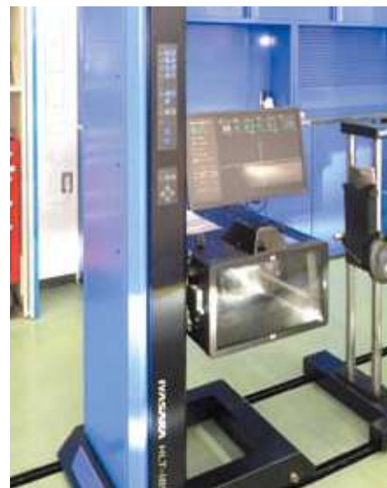
受光部の上下動が手巻き式からボタン式に変わったヘッドライトテスター
