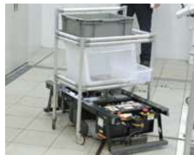
部品はロボットが部品庫から自動運搬
