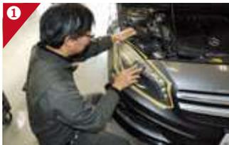
1 状態によって600番のサンドペーパー（耐水ペーパーを使用した方が耐水でなくとも可）で表面を磨く
