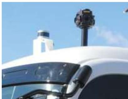
左：レーザーセンサー 中央：全方位カメラ
