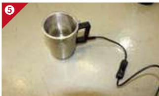
5 HLSCは溶剤を専用のマグカップに入れ、電気（電源コードは4.5mと作業性が高い）を使って加熱していく
