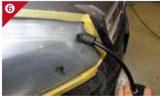
6 溶剤が沸騰してきたら塗布が出来るので、専用のノズルを使ってヘッドランプに蒸気を当てていく
