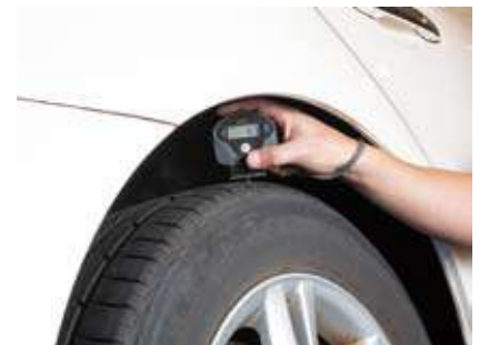
タイヤデプスゲージにて計測を開始。計測後、即、測定結果を通信で飛ばせるので、見間違い、転記間違いはゼロ。
