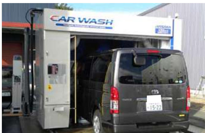
従来機では約10m必要なレールが8mで済む新型省スペース門型洗車機「アンブルコンパクト」。操作部が両側の柱にあるのも特徴。
