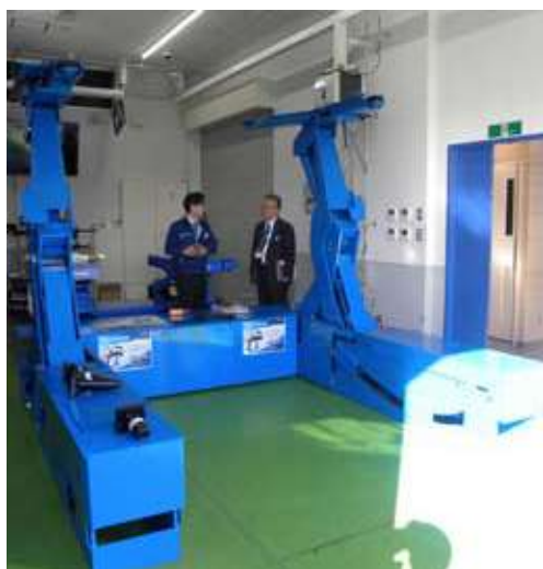
国内初となるパンタ式スイングアームタイプのアヴェンタスリフト。ピットの深掘が不要なので、階層工場にも設置可能。
