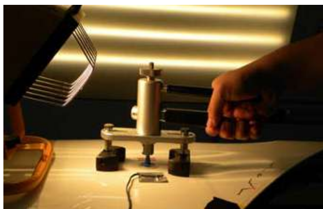
温間接着修正方式により最小限の面積でアルミパネルの凹みを圧倒的短時間で修復できるリペアキット（特許取得済み）。
