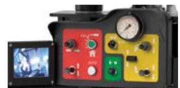
**電気式クイックロック** … コントロールボタン操作の電気式センターロックシステムの採用で、簡単に確実なクランプが可能になった。
