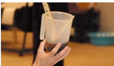
下回り防錆塗装後に余剰分が常温硬化した「テイトPFR」。高い弾性を維持している
