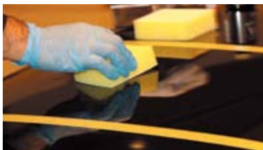
R、H、Mいずれも主剤と硬化剤を混ぜたら専用のスポンジでムラ・隙間なく塗布する
