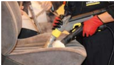
「SG 4/4」で蒸気をかけた直後に「Puzzi 8/1 C」で水分を吸引すれば効率良く洗浄可能
