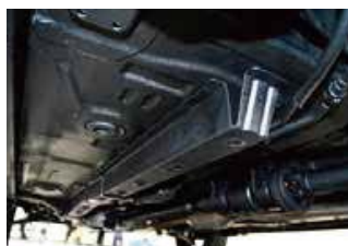
ハイアートCB エコ防錆コート 施工写真
