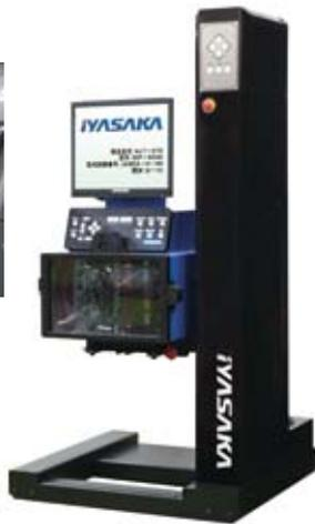
LED・HID・プロジェクタ・ハロゲン各種ランプに対応した最新画像処理方式のヘッドライトテスター。押しボタンスイッチによるワンタッチ操作で、車両のランプ位置に移動し、受光すると自動でランプ正対後、測定を行う。
