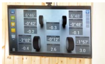
測定した結果は正面のモニターに瞬時に表示される
